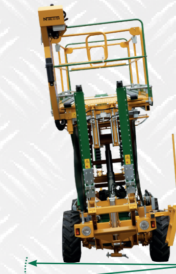
A RICHIESTA DISPOSITIVO DI INCLINAZIONE LATERALE DELLA MACCHINA E LONGITUDINALE DELLA PIATTAFORMA ON REQUEST PLATFORM TILT CONTROL: HYDRAULIC LEVELING AND BALANCING OF THE PLATFORM
