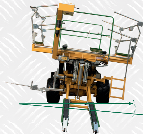
SISTEMA PER IL CONTROLLO DELLA PIATTAFORMA SU PENDENZE LATERALI SYSTEM CONTROL PLATFORM ON SLOPS LATERAL
