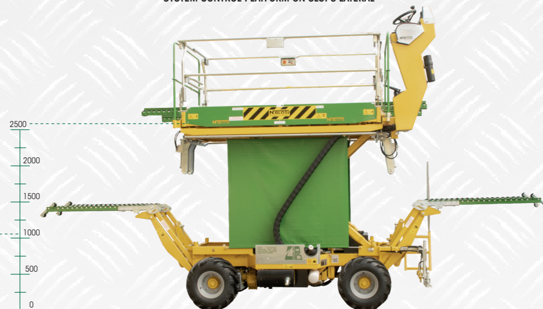
SISTEMA PER IL CONTROLLO DELLA PIATTAFORMA SU PENDENZE LATERALI SYSTEM CONTROL PLATFORM ON SLOPS LATERAL
